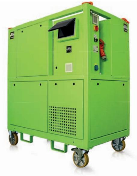
Bei Bedarf, z. B. bei einer Änderung des Mischungsverhältnisses, kann der Mischbehälter komplett abgesaugt werden (Endvakuum < 1 mbar). Der integrierte Vakuumkompressor ermöglicht ferner die komplette Entleerung von Druckgasflaschen, so dass eventuelle Restmengen der Isolierfluide Novec 4710 bzw. Novec 5110 komplett dem Mischvorgang zugeführt werden können und kein Gasverlust entsteht. Ein Gerät, das neueste Technologie und Wirtschaftlichkeit vereint.
