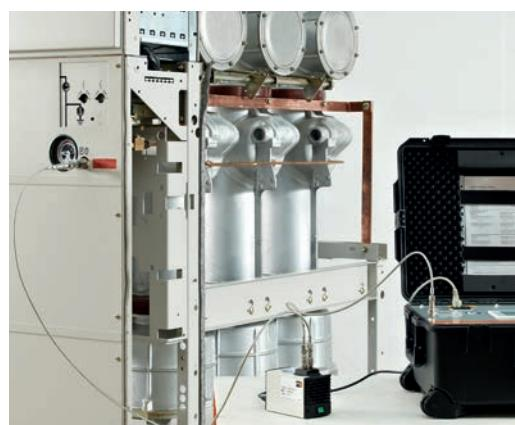
Der Membrankompressor wird mit dem dazugehörigen Anschlussschläuch zwischen den Mittelspannungsschalter und das Messgerät geschaltet.
