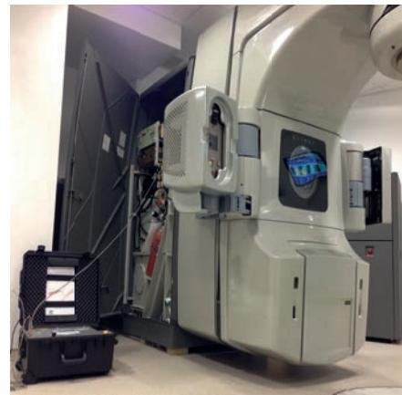
Die Wartungseinheit B160R92 ist auf die Anforderungen kleiner Gasräume abgestimmt. Im Bild: Das Gerät bei Servicearbeiten an einer Bestrahlungseinheit.
