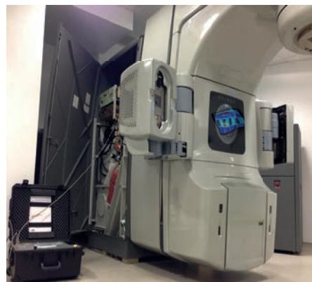
Die Serviceeinheit B160R11 ist auf die Anforderungen kleiner Gasräume abgestimmt. Im Bild: Das Gerät bei Servicearbeiten an einer Bestrahlungseinheit.
